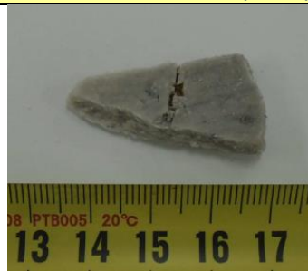
Fragment de plaque amiante-ciment avant puis pendant traitement en réacteur
