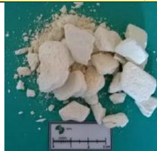
Silice amorphe de haute pureté après extraction du réacteur et séchage
